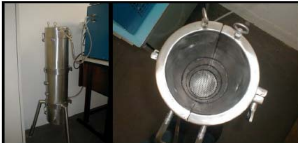
Reator para aplicação em Sistemas de Alagados Construídos aerados.
